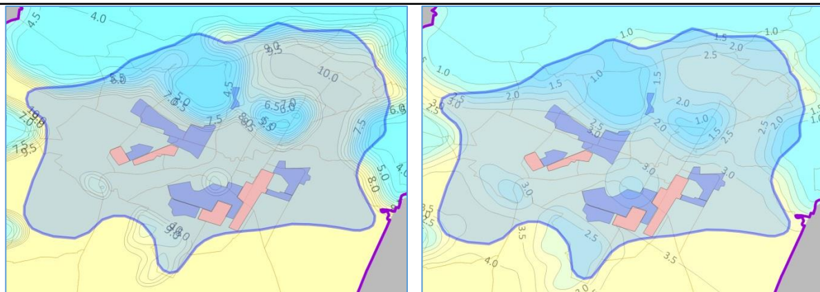
Slika br.2.55. Potencijalne štete za klasu zidanih objekata sa nosećim zidovima (lijevo) i zidanih objekata sa AB ukrućenjem (desno) na području urbanog područja Glavnog grada Podgorica, po metodologiji ATC-21-1 u slučaju realizacije najnepovoljnijeg scenarija zemljotresa (na rasjedu R3). Štete su izražene u procentima ukupnog stambenog fonda specificirane klase objekata.
