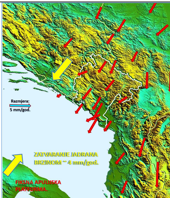
Slika br.2.8. Kinematski horizontalni vektori segmenata zemljine kore na prostoru Crne Gore i okruženja, u uslovima relativnog fiksiranja apulijske platforme, na osnovu višegodišnjeg permanentnog GPS osmatranja na većem broju stanica Crne Gore i okruženja, ukazuju na geodinamički proces subdukcije jadranske mikroploče ispod Dinarida i Apenina i njihovom međusobnom konvergencijom - ukupnom brzinom od oko 4 mm na godišnjem nivou (Glavatić et al., 2011).
